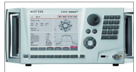
Bild 1: Meßplatz für Tetra-Funkgeräte – der 2303 Stabilock von Willtek
