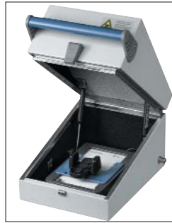
Bild 4: Tetra-Testkammer mit Antennenkoppler
