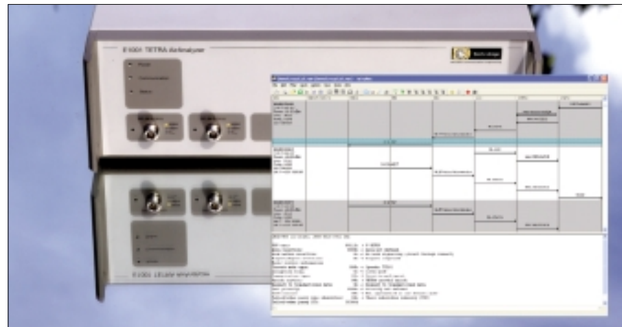
Durch Auswertung des Datenverkehrs auf der Luftschnittstelle werden Fehler und Versorgungs-Engpässe aufgedeckt
